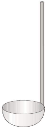
36. Colher de combustão Utiliza-se para aquecimento de pequenas quantidades de sólidos.
