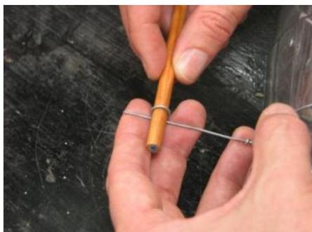
B) Pegue um lápis e encoste-o no arame preso ao bico, a cerca de 10 cm do bico. Em seguida dê uma volta com o arame em torno dele, bem firme. Você fez uma argola para passar o fio de nylon condutor.
